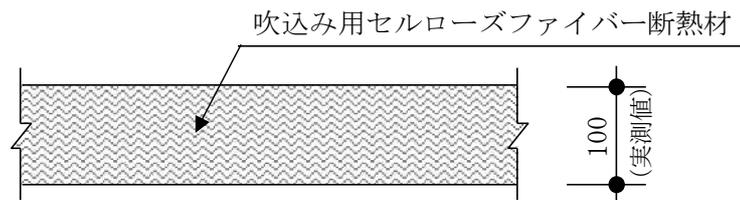
図1 試験体の断面見取り図 (寸法単位: mm)
